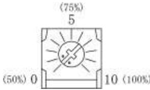
（下図の停止時電流は駆動電流に対する比率です。）
