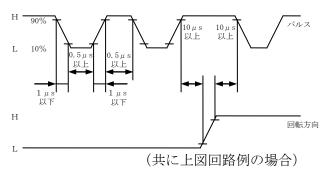
注:・CW回転とは、モーター軸がモーター取付フランジ面より 見て時計方向に回転することを表します。 注:CW, CCW信号でVoが5Vを越える時は外部抵抗R1を接続して下さい。
